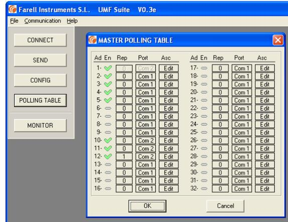
En la pantalla del ejemplo podemos observar que la red está compuesta por el módulo master (Ad = 1), 4 módulos esclavos remotos (Ad=2, 3, 4, 5) que comunican con el master a través de Com1 de éste (posible radiomodem) y 3 módulos locales (Ad=10, 11, 12) conectados al master a través de Com2 de éste.
