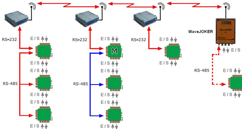
En este modo una red de UMF-100 (color rojo, en la figura) se comunican por radio mediante equipos radio-módem para pasar estados de entrada (entradas digitales y analógicas) a estados de salidas (digitales o analógicas) entre módulos. También, y de forma simultánea o única, puede existir una red local por cable (RS-485) (color azul, en la figura) con uno o más módulos.
