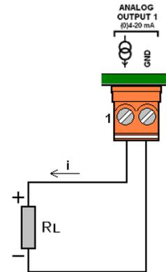
$$R_L (\Omega) \leq 50 (V_{\text{module}} - 5)$$
