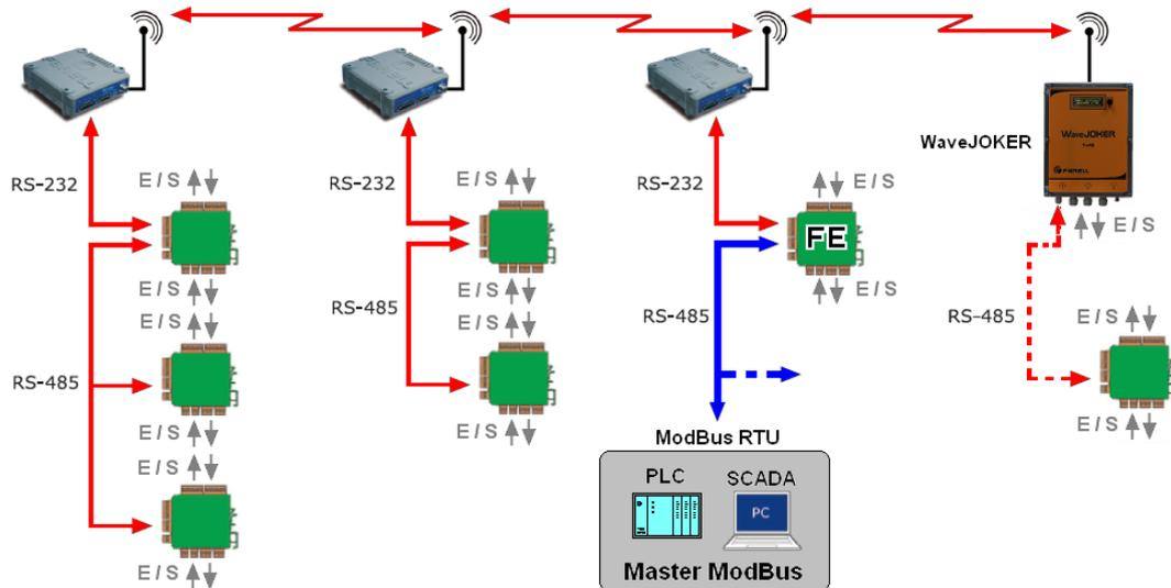
En este modo una red de UMF-100 se comunican por radio de forma autónoma (color rojo, en la figura) mediante equipos radio-módem para leer y/o escribir estados de entrada y salida digitales y analógicas, contadores y medidas internas. Un módulo UMF-100 configurado como Front-End (FE en la figura) actúa de maestro de esta red radio a través de su COM1.
