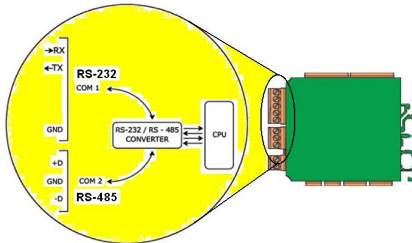
En este modo un módulo UMF-100 se emplea únicamente como **conversor** de interfase **RS-232 / RS-485 inteligente** (sin señales de control), **para cualquier protocolo**.
